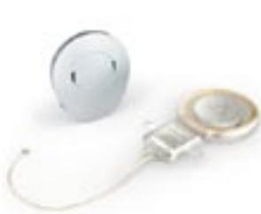
Bei Vibrant Soundbridge und Bonebridge handelt es sich um Hörimplantatsysteme, welche den akustischen Schall in Form mechanischer Schwingungen an die vibrationsfähigen Strukturen des Hörsystems übertragen.
