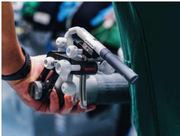
Die OP-Assistenzsysteme OTODRIVE und OTOARM unterstützen Chirurg:innen bei präziser und strukturschonender Cochlea Implantation
